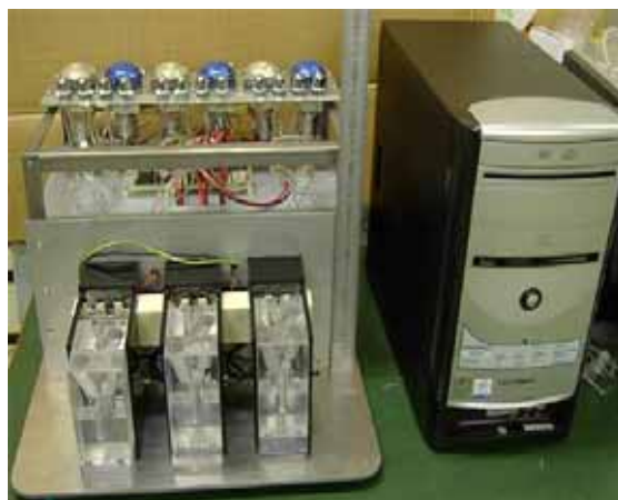
「次世代医療システム産業化フォーラム」で共同開発を支援した案件のうち、試作機開発に成功した「再生医療用 培養液中の無菌検査装置」(従来数日~十数日を要した無菌検査を半日で完了、将来的に簡便な装置に仕上げ、再生医療への普及が期待される)。
